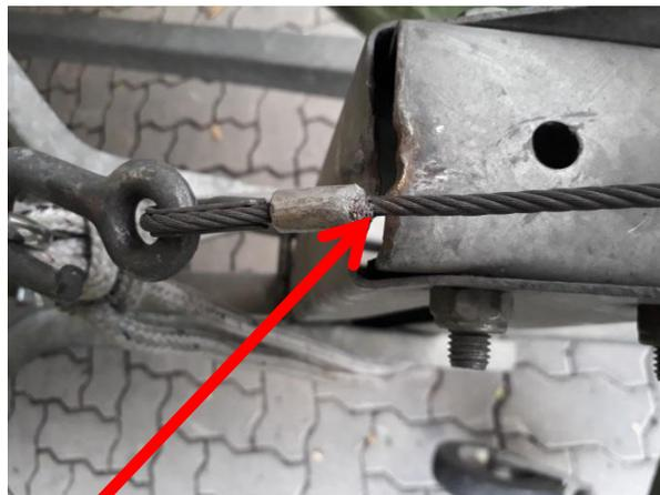
11. Das Boot wird bis zur markierten Stelle, Seilverpressung und Hängerrahmen gezogen. So sind beide Stahlseile gespannt.
